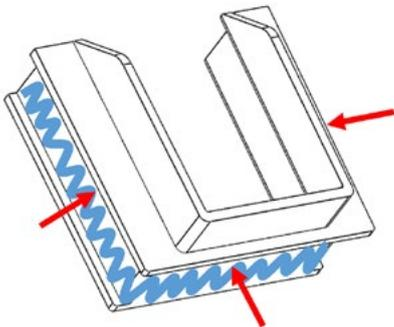
2. Instalar la pieza en el canalón desde el interior de la columna, con precaución de no retirar la silicona en el proceso.
