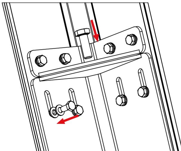
3. Atornillar sobre la base L una pieza de acople del perfil embellecedor mediante un tornillo DIN 933 A2 M6x10. (3)
