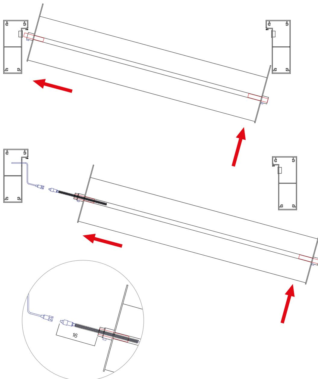
Instalar las lamas inclinándolas con las aletas de los testeros hacia abajo, introduciendo en primer lugar el eje fijo (izquierda) y posteriormente, el eje móvil (derecha).
