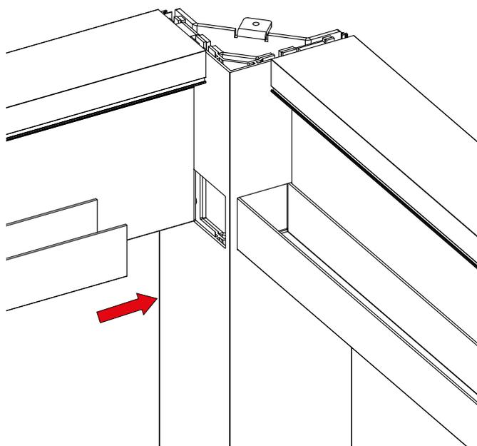
Comprobar que todos los orificios del perfil "U" coinciden con los mecanizados de M6 de las vigas. Si todos coinciden, aplicar sellador entre el perfil "U" y la viga, así como alrededor de los orificios de los tornillos, después atornillar los perfiles por medio de los tornillos ULS (ISO 7380) A2 M6x16.
