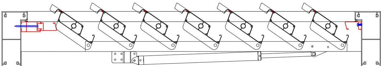
4. Por último volvemos a instalar el soporte del motor en el perfil "U" con sus 2 tornillos (A).
