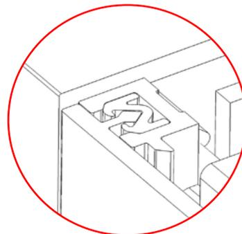
En la parte superior del clipaje derecho, desatornillar ligeramente el tornillo de la pieza de acople del perfil embellecedor, para poder colocar el perfil en su sitio. A continuación, volver a atornillar hasta que la columna se quede totalmente cerrada.
