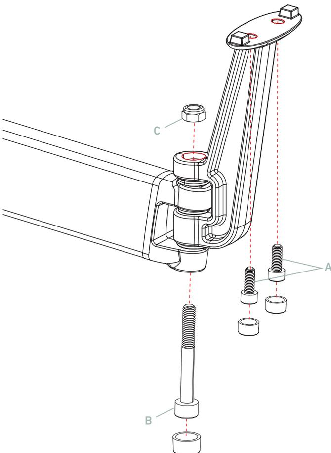
Para el brazo que utiliza el kit de brazo cruzado, insertar los dos tornillos Allen **A** de la regleta por los orificios del terminal y sujetarlos a la citada regleta.
