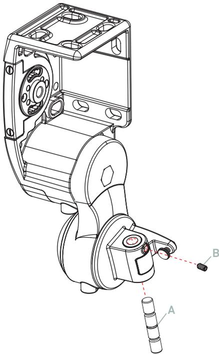
Con todo el tejido prácticamente enrollado en el tubo, sacar el vástago de sujeción de la horquilla del brazo **A**.
