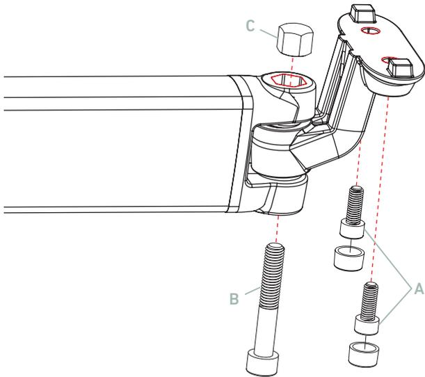
Insertar los dos tornillos Allen **A** de la regleta por los orificios del terminal y sujetarlos a la citada regleta.
