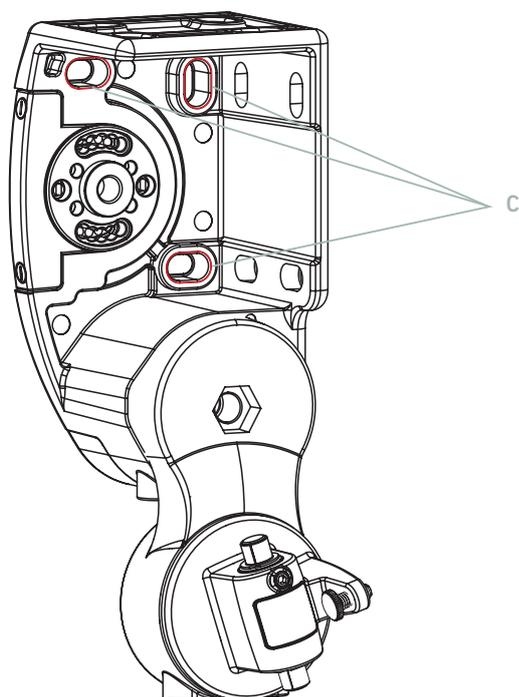
Cuando la fijación se desea entre paredes, debe perforarse los agujeros premarcados en el soporte **C**. Para introducir los correspondientes anclajes.
