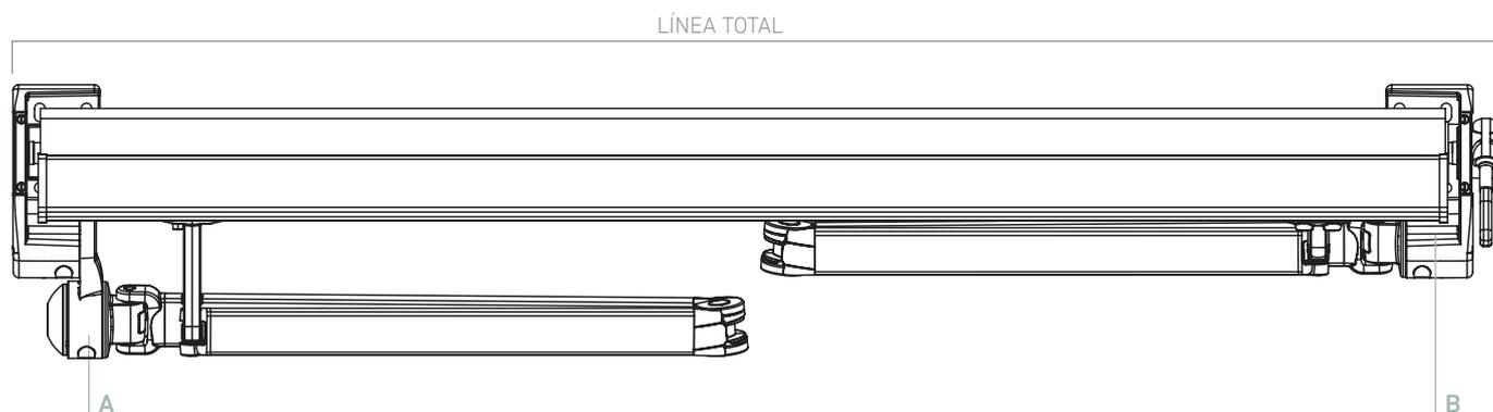
Cuando colocamos los soportes a sujeción frontal **A** o a techo **B**, y la máquina por el exterior, la línea total se determina de soporte a extremo de máquina.
