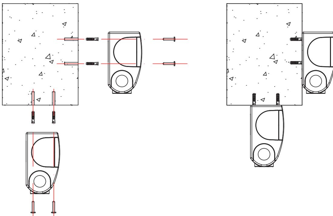
Posicionar los soportes (frontales o a pared) a la distancia correcta. Para ello medir la línea del toldo ensamblado (de soporte a soporte). Ambos soportes deben estar posicionados al mismo nivel.
