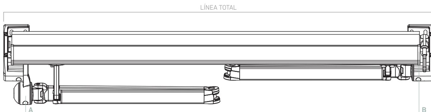
Cuando colocamos los soportes a sujeción frontal **A** o a techo **B**, y la máquina (o motor) por el interior, la línea total se determina de soporte a soporte.
