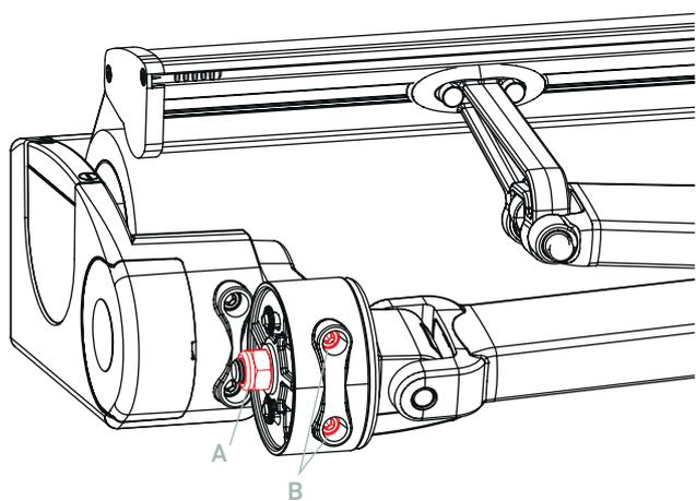
Para nivelar la inclinación de los brazos, aflojar ligeramente el tornillo **A** y actuar con una llave Allen del 7 mm sobre los dos tornillos **B** de doble regulación que tiene este nuevo soporte.
