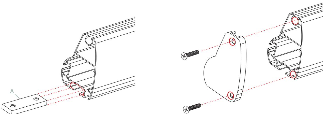
Insertar en la ranura inferior del perfil delantero **TOLPER** la regleta **A** que sujetará el terminal.
