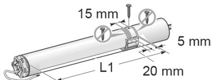
**3.3.2** Por motivos de seguridad, fije el tubo de enrollamiento en la rueda con 4 tornillos Parker de  $\varnothing 5$  mm o 4 remaches Pop de acero de  $\varnothing 4,80$  mm situados:
