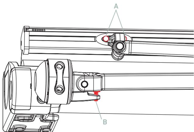
Una vez hecho esto, cerrar el toldo completamente y apretar los tornillos Allen **A** de ensamble entre el terminal y la regleta.
