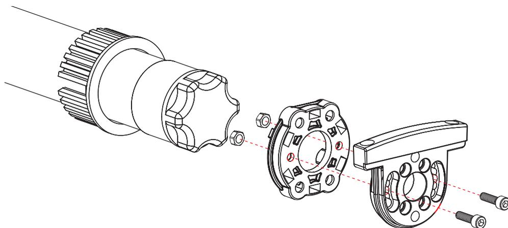
Fijar el soporte motor, tal y como se observa en la imagen con las tuercas y tornillos directamente sobre el lateral del conjunto soporte **ORUS**, dejándolo fuertemente sujeto.
