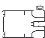
Inserire il binario guida della maniglia nell'apposito alloggiamento del profilo della zanzariera.
