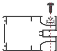
Una volta posizionato, fissarlo al profilo utilizzando le viti in dotazione.
